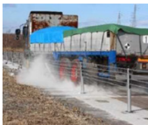
ワイヤロープ式防護柵の衝突実験(共同研究)
