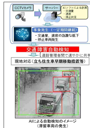
交通障害自動検知システム
