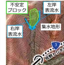
高度化された点検手法の例 レーザープロファイラ調査結果
