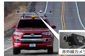
赤外線カメラによる コンクリート床版の点検
