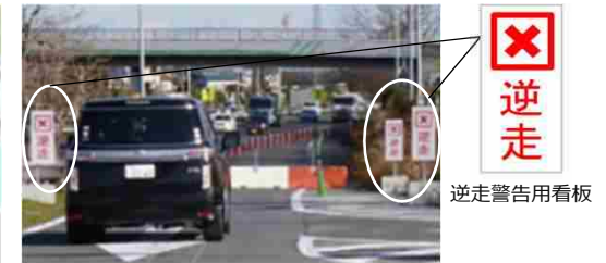
逆走警告用看板を車載カメラが読み取り、 ドライバーに警告を発出
