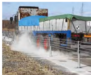
ワイヤロープ式防護柵の衝突実験(共同研究)
