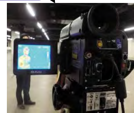
検温設備(サーモグラフィ)
