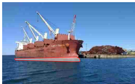
約30000DWT船 →現状は水深の制約により満載で入港できない
