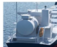
新燃料貯蔵・供給・燃焼システム
