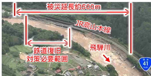
<護岸洗掘による国道41号の被災状況>
