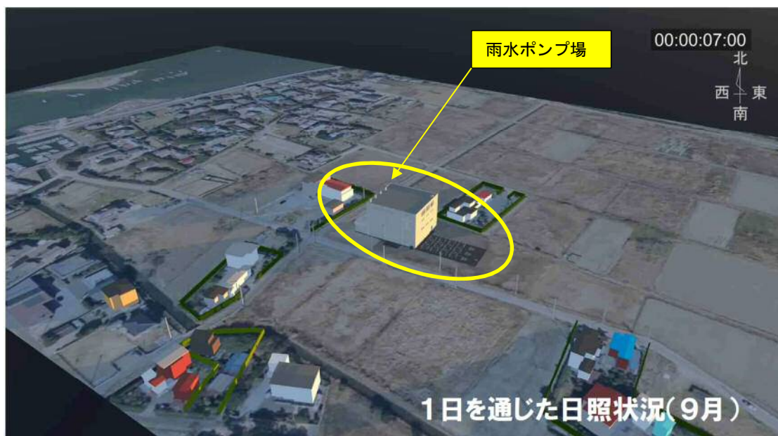
図 34 地形モデルと土木建築モデルを統合し日影検討に利用した例（LOd：30 相当）
