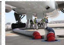
エアコン供給の様子
