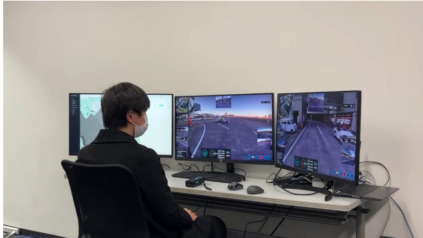
2台試験(走行中映像+FMS画面)での監視/駆けつけ実験様子 (ローカル5G通信利用) ※すれ違い走行
