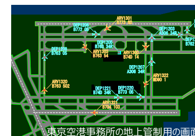
東京空港事務所の地上管制用の画面
