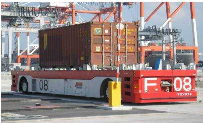
自動搬送台車 (AGV)
