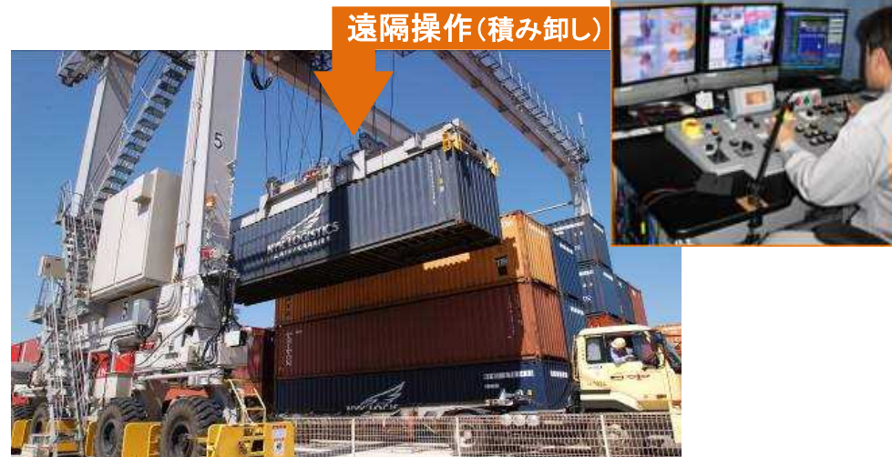
遠隔自働ラバータイヤ式ガントリークレーン(遠隔自働RTG)
