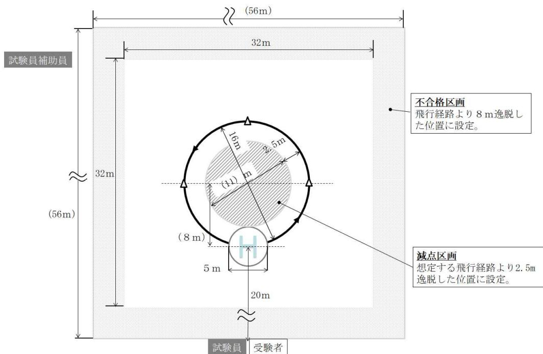
※1：受験者が飛行経路を想定する際の目安とするため、直径16mの円上に目印を置くこととする。ただし、目印の上空を飛行することを必須としない。
