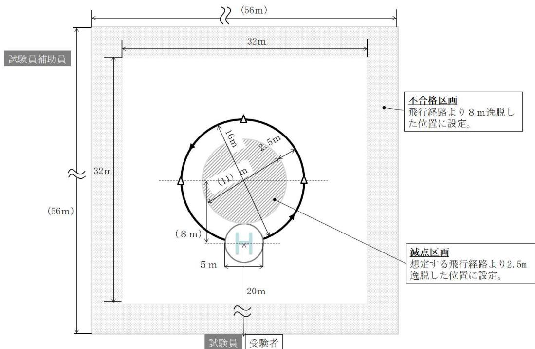
※1：受験者が飛行経路を想定する際の目安とするため、直径16mの円上に目印を置くこととする。ただし、目印上空を飛行することを必須としない。
