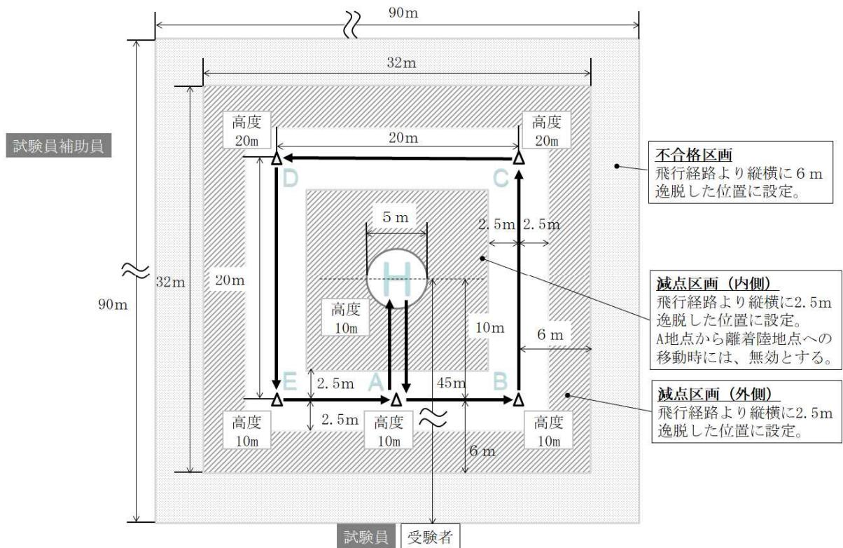
※1：試験員補助員の位置は、逆順の飛行ではC側とする。
