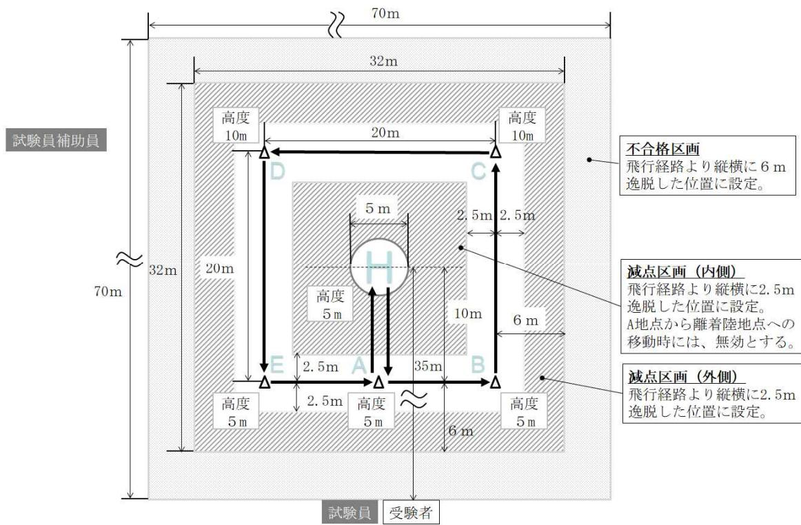
※1：試験員補助員の位置は、逆順の飛行ではC側とする。
