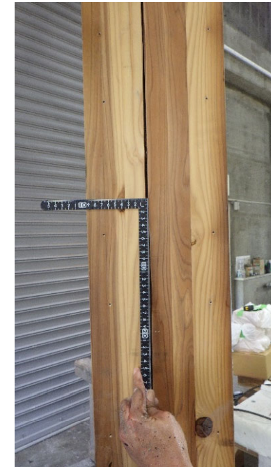
加熱後 接着部分の割れ
