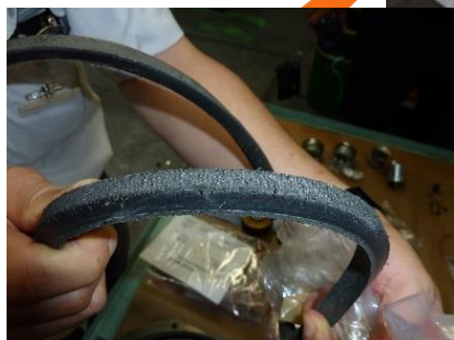
Vベルトの劣化
