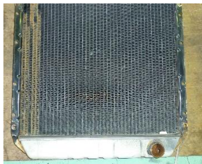
ラジエータフィンの劣化
