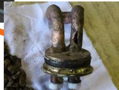
制御装置端子部の腐食
