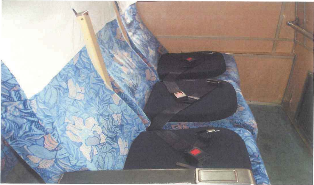
テンピュールシート設置状況(左舷)
