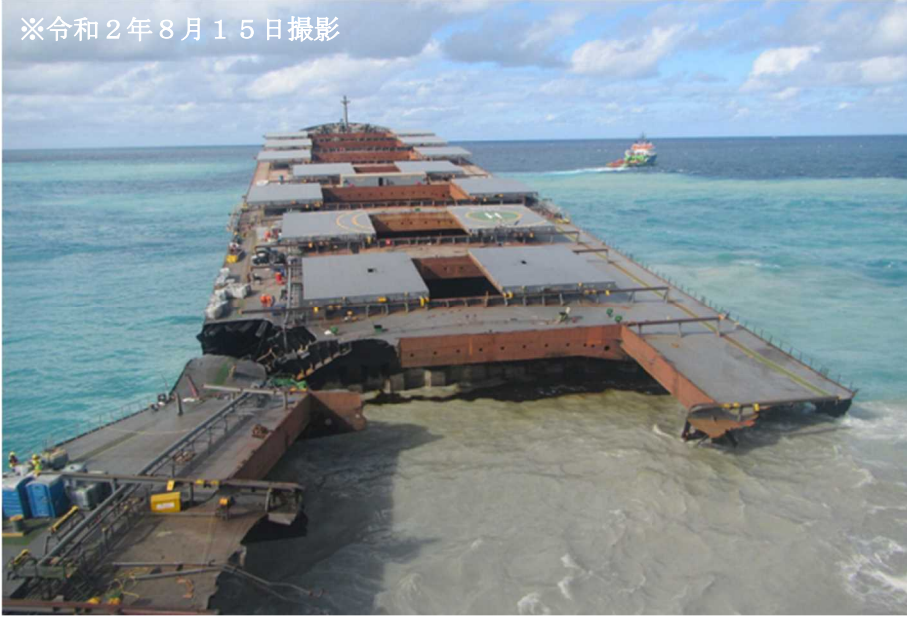
写真9 本船の船尾部から分離した船首部
