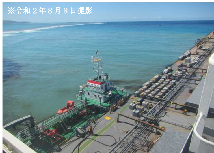
写真7 タンカーによる燃料油の汲み出し作業
