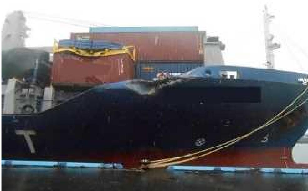
写真2 B船の損傷状況
