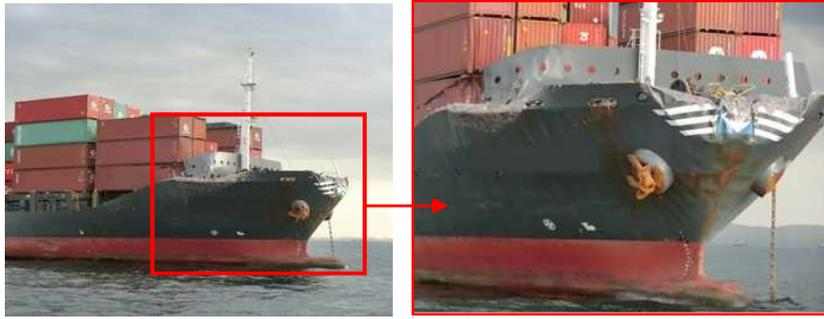
写真2 B船の損傷状況
