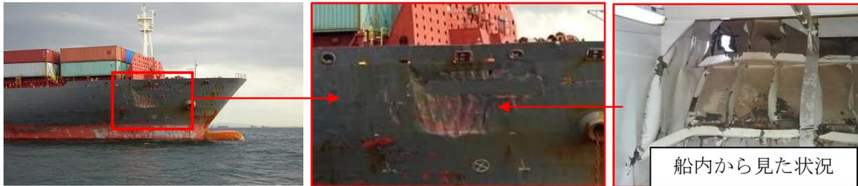
写真3 C船の損傷状況
