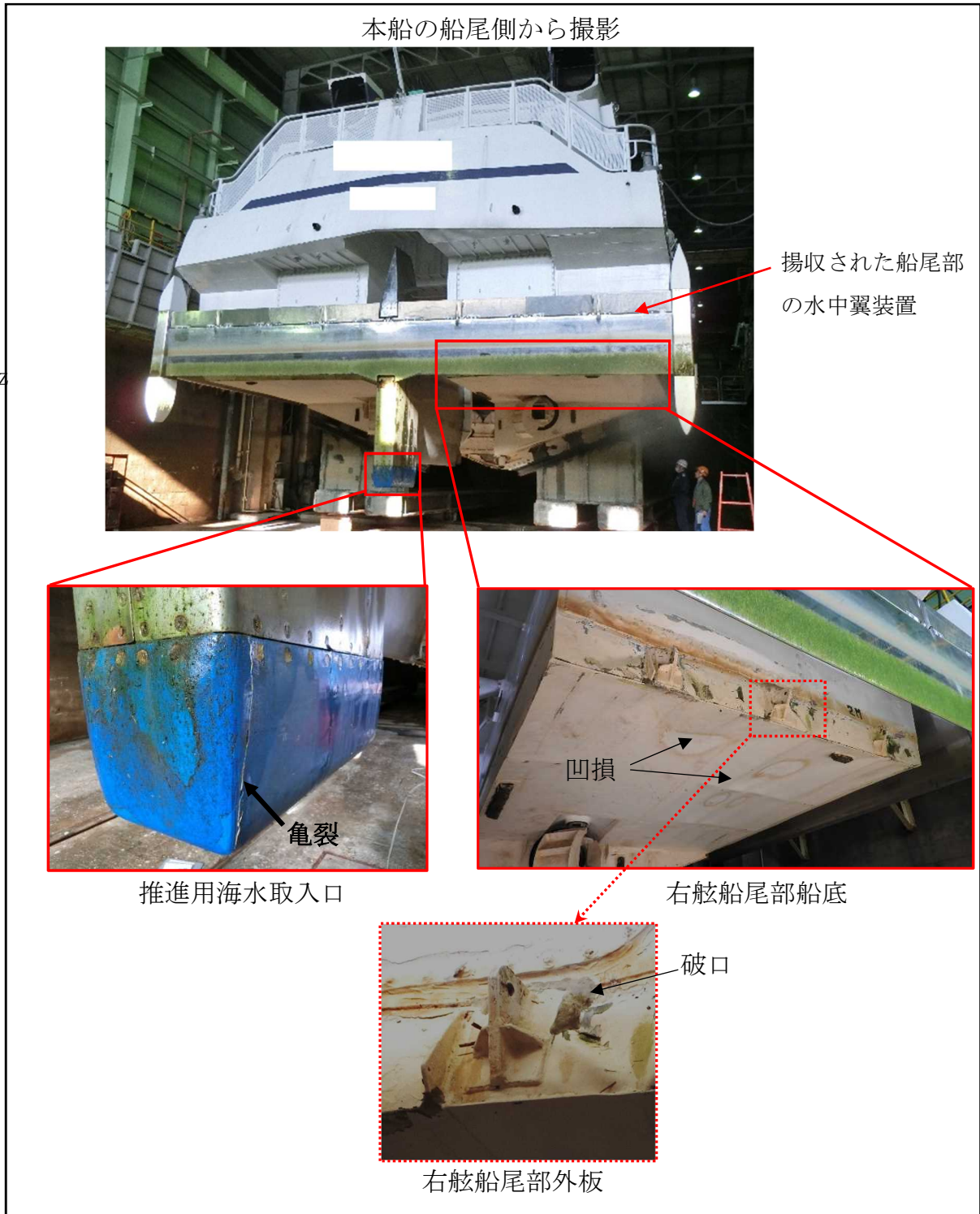
図 2. 3 損傷状況
