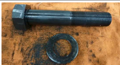
写真2 据付ボルトと同型のボルト
