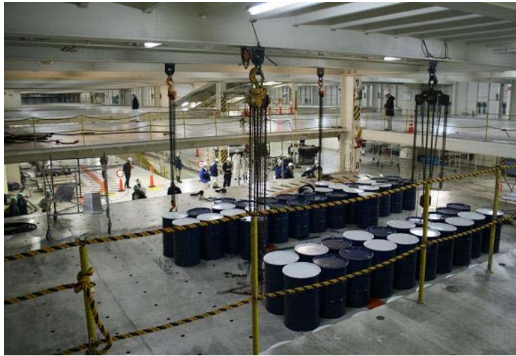
写真3 本件デッキパネルのたわみ量の計測状況
