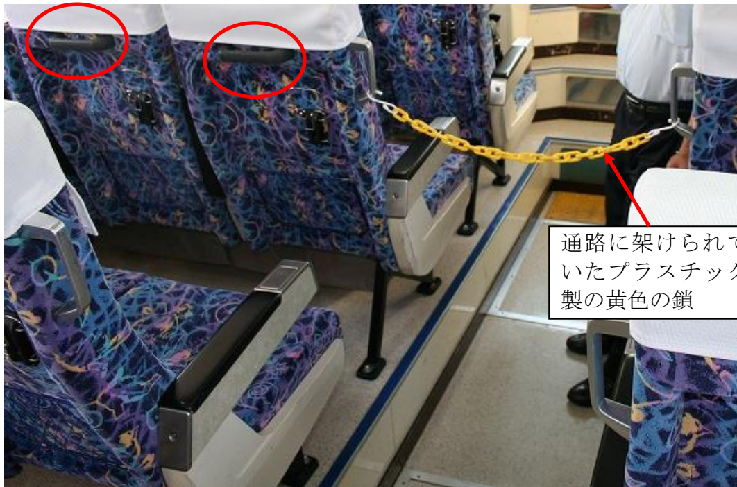
写真 7 - 3 前部客室の座席の手すり
