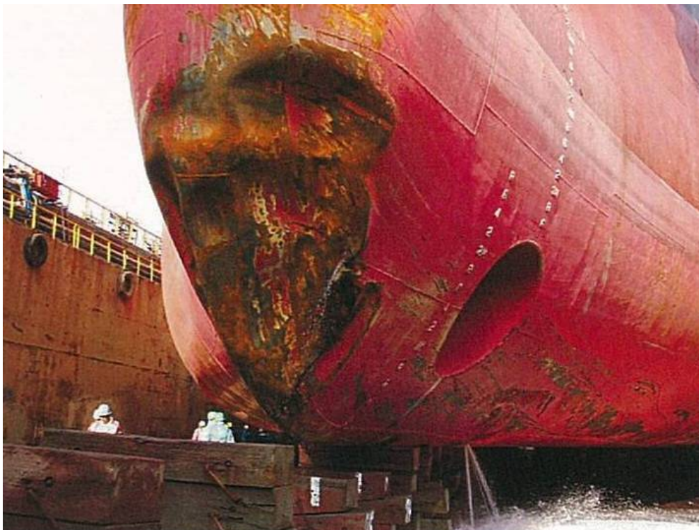
写真4 A船のバルバスバウの損傷
