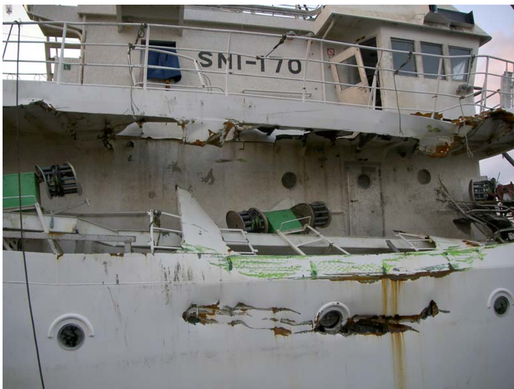
写真3 B船右舷中央部損傷状況
