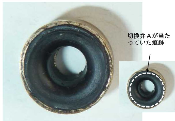
図10 本件弁座枠を上から見た状態
