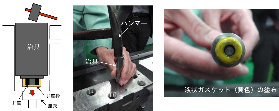
図4 弁座枠の座穴への圧入工程
