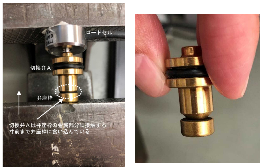
図 1.1 切換弁 A と弁座枠の圧着試験（左：加圧状態、右：取り外し後）
