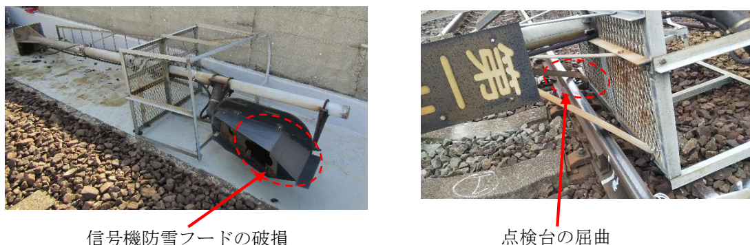
図4 本件信号機の損傷状況
