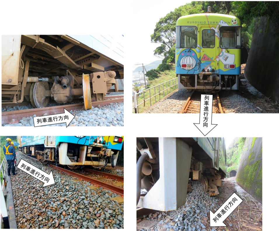
付図 1 4 脱線の状況 その 2
