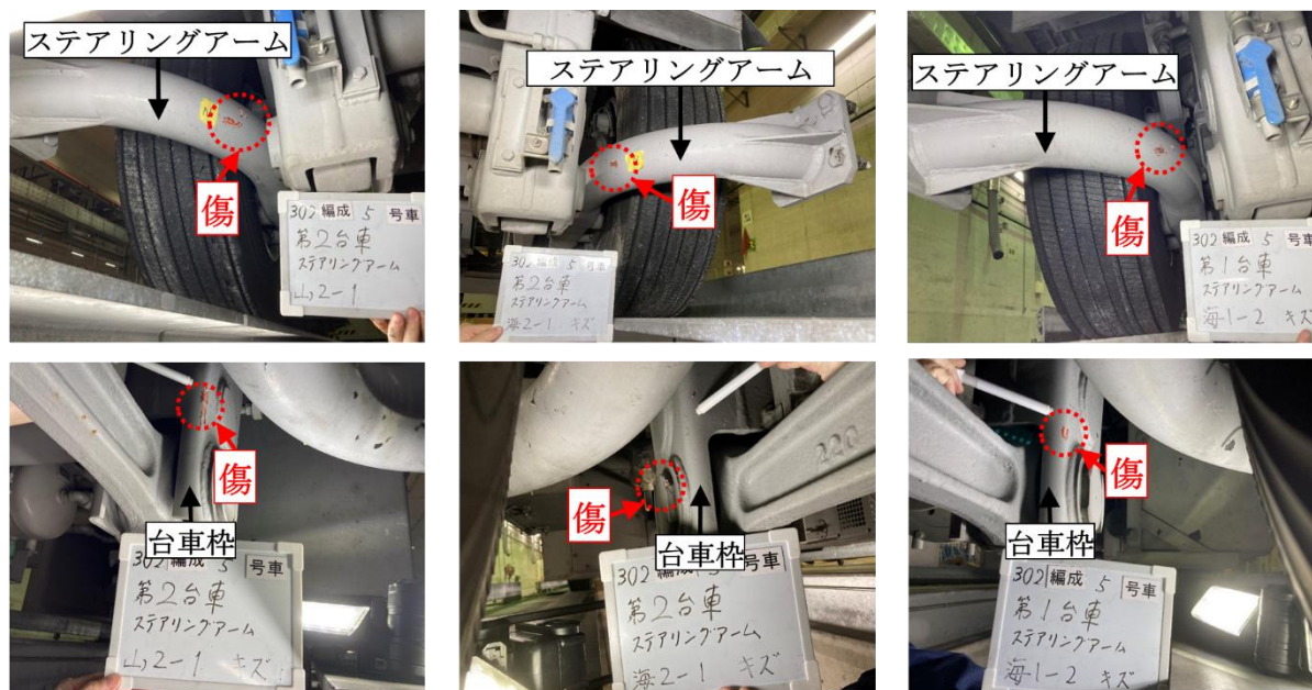
(b) 台車の損傷状況
