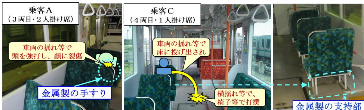
図3 本件列車の乗客の負傷例と車内設備の状況
