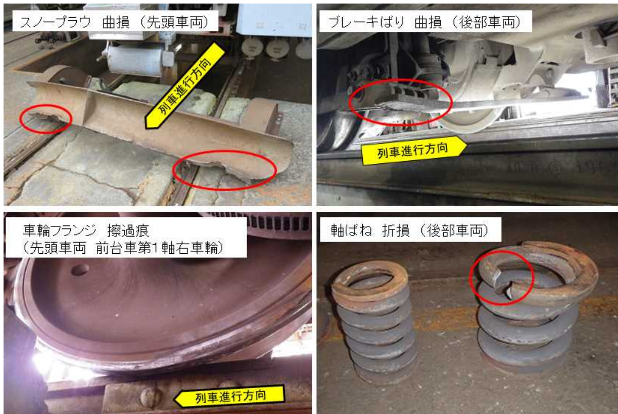
図5 本件列車の損傷状況
