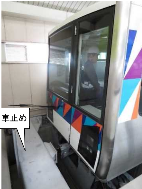
車止めへの衝突の状況（5両目）
