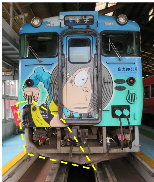
図7 列車前面（車両基地で撮影。点線枠は、何らかの損傷が認められた大まかな範囲）
