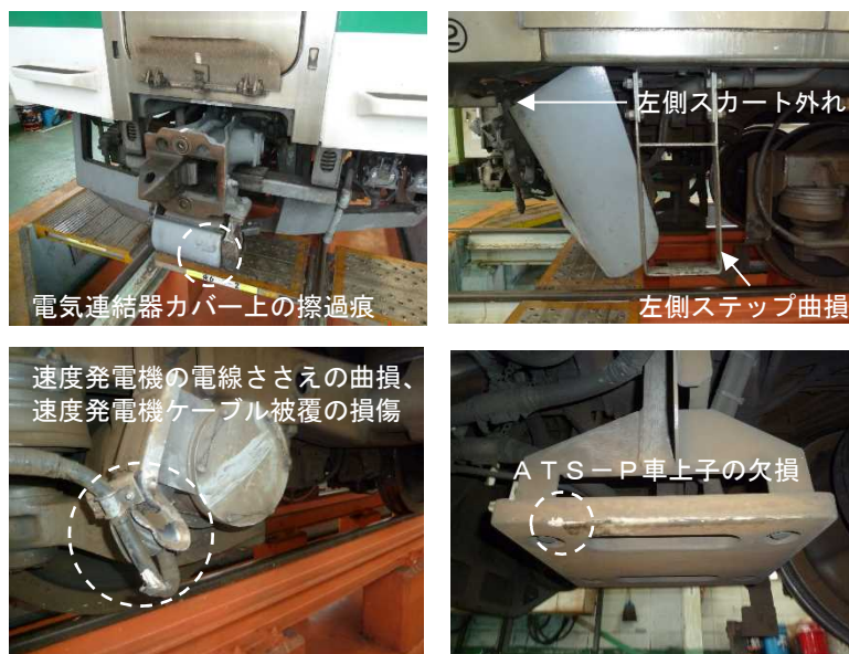
図5 車両の損傷状況
