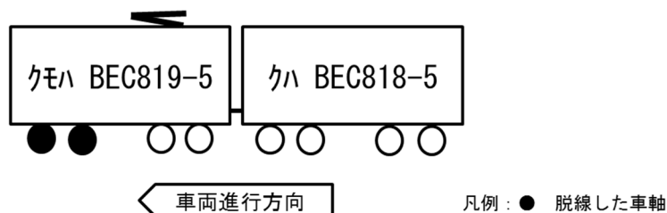
図4 本件編成車両の編成と衝突により脱線した車軸の部位
