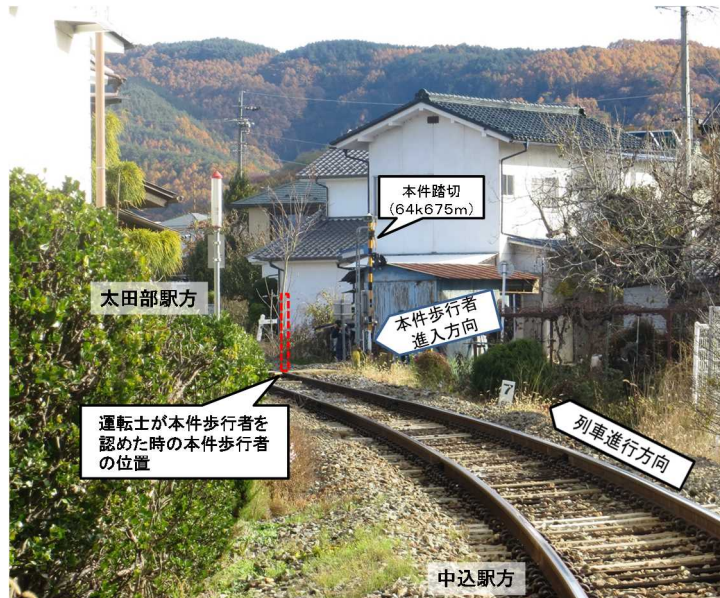
写真2 列車から見た本件踏切の見通し (本件踏切から約95mの位置)
