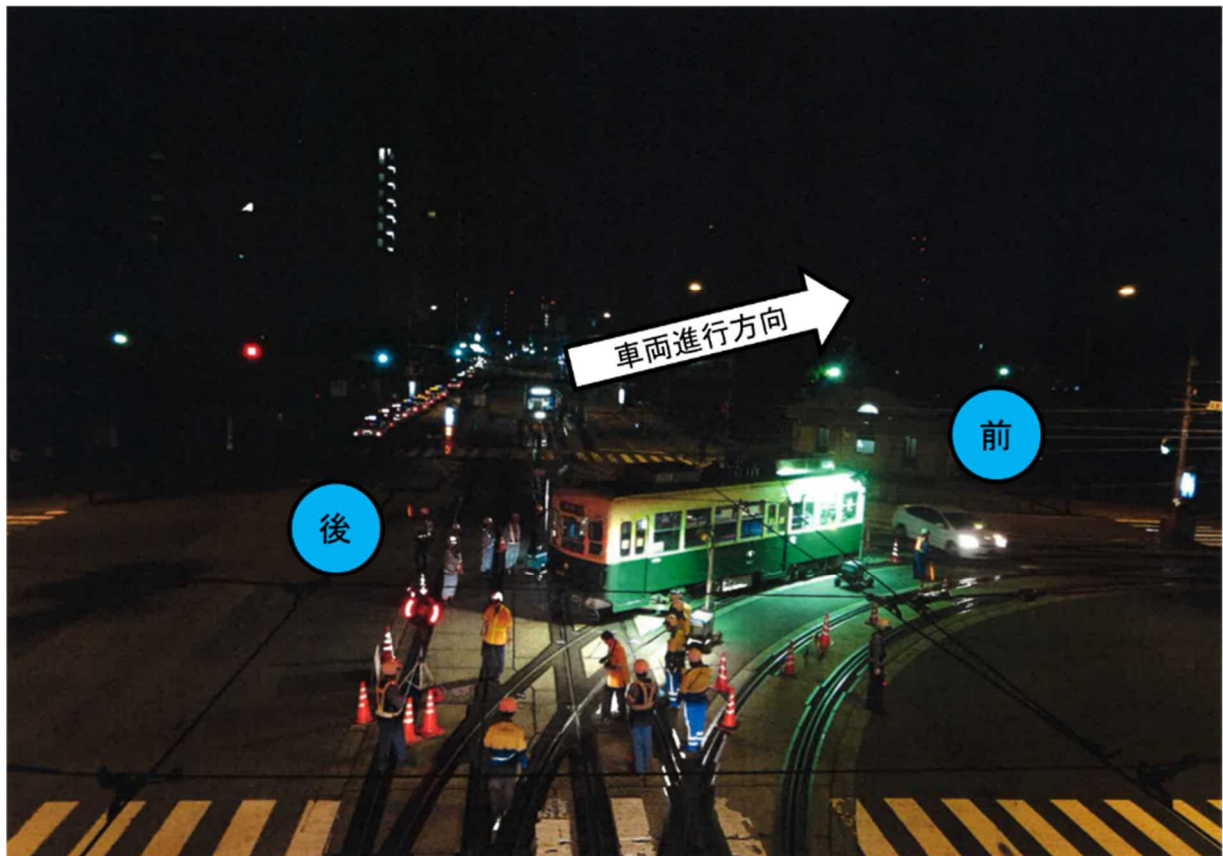
写真2 本件電車の脱線の状況
