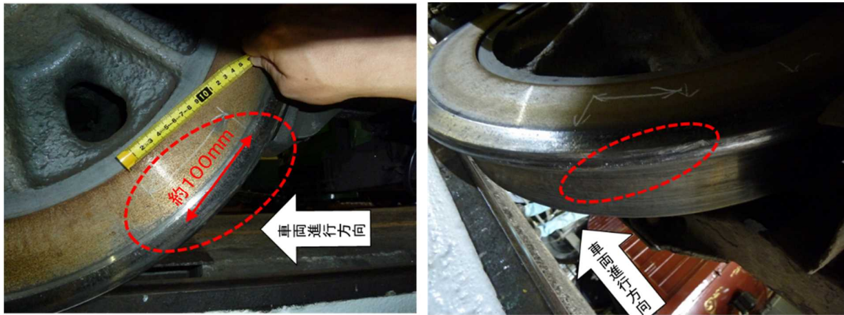
付図5 車輪の脱線の痕跡
