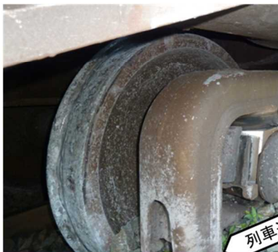
第1軸左車輪の踏面描写と写真
