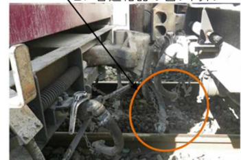
9両目(左)と10両目(右)のBP管連結器の分離
