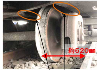
後台車第2軸上方の車体の損傷
