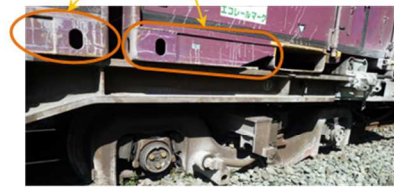
コンテナ脚部の擦過痕
