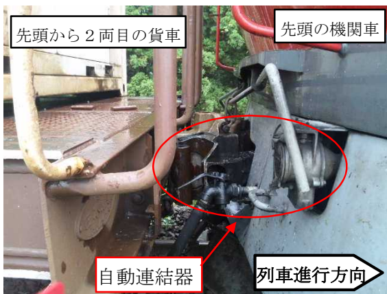
自動連結器のナックルが横方向にずれた状況
