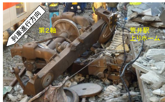
事故後に車体を撤去した後の前台車の状況
