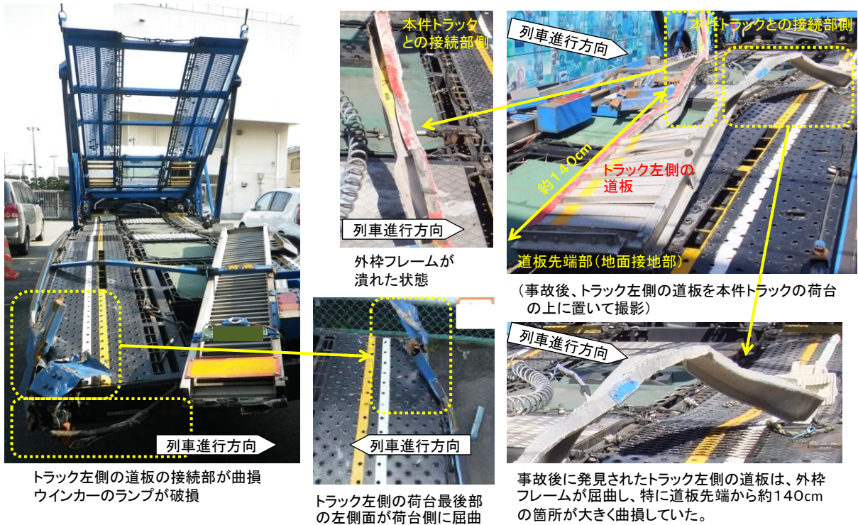
付図 1 5 本件トラックの主な損傷状況
