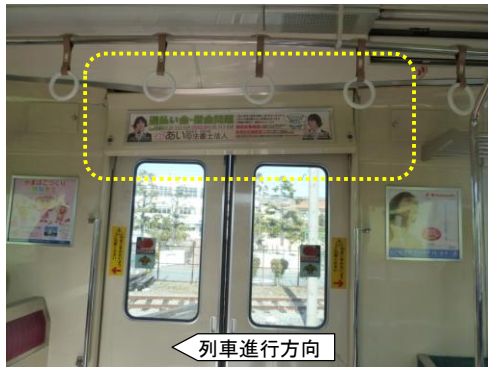
右側一番後ろの旅客用扉天井付近が屈曲
