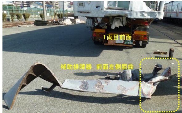
補助排障器の前面左側が屈曲(車両基地にて撮影)
