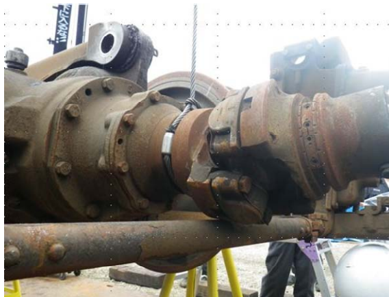
自在継手がブレーキつなぎ棒に接触した状態
