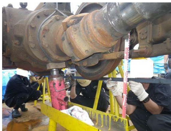
人力での回転が不能になった状態
