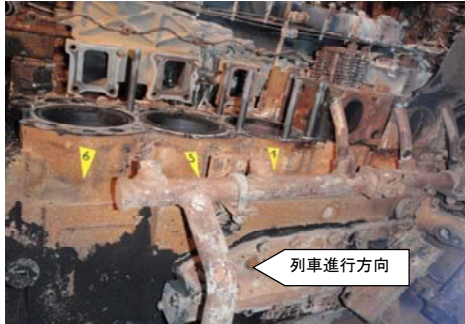
シリンダーヘッドを外した状態 (下面より見る.)
