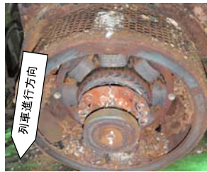
排風カバー、軸受を 取り外した状態
