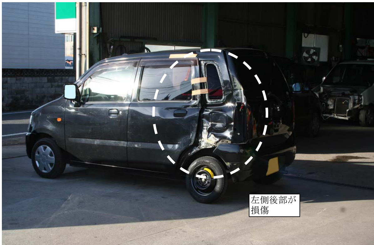
写真6 軽自動車の損傷状況
