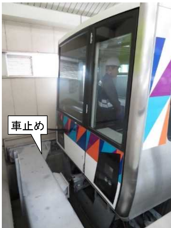
車止めへの衝突の状況 (5両目)
