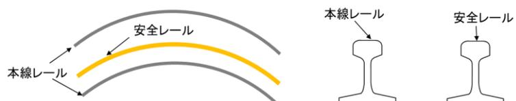
脱線防止ガードや脱線防止レールは脱線そのものを防止することを目的として敷設されるものであり、一方、安全レールは脱線したあとの逸脱を極力防止する目的で敷設されるものである。脱線事故防止の観点から、可能な限り脱線防止ガード又は脱線防止レールを敷設することが望ましい。
