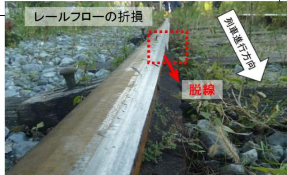
※「レールフロー」とは、レール頭頂部を車輪が繰り返し通過して大きな接触圧が生じることにより、レール表面の金属が塑性流動してレール頭側面又は端面にはみ出したものをいう。
