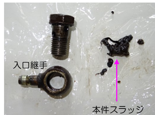
1次ストレーナ入口継手及び本件スラッジ
