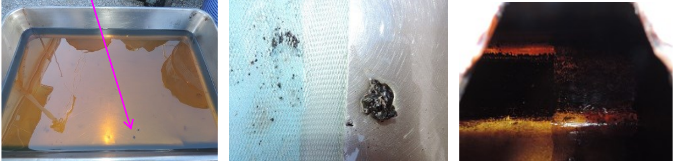
燃料油タンクから抜き出した軽油
