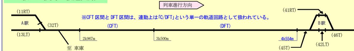
シミュレーションの結果、A 駅出発時以外はマスコンによる力行操作を行わなかった場合(※1)は、上記条件を満たす走行はできず、一方、C/DFT 区間の上りこう配区間の一部でマスコンによる力行操作を行ったとすれば、5504 号の応荷重制御(※2)が認識した乗車率が 0%~50%の場合(下図参照)、上記条件を満たし、運転士及び車掌の口述の概略にも沿った走行が可能となりました。
