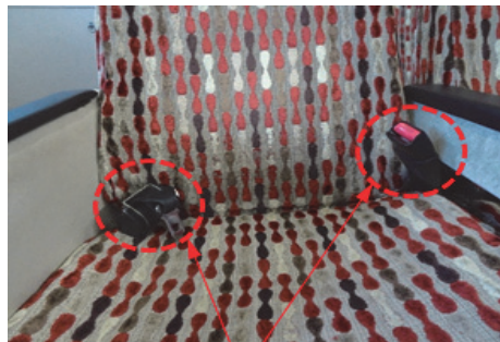
旅客船ぎんがの自動巻取式の 2 点式シートベルト
