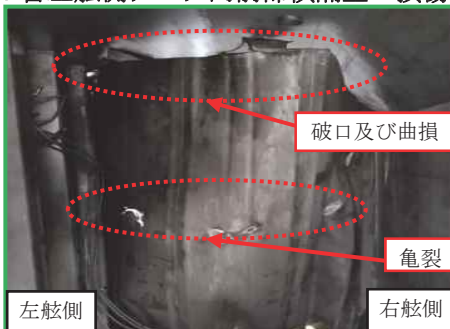
(3番左舷側タンク内前部横隔壁の損傷状況)
