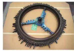
LPT第5段（左側）及び第6段（右側）動翼の損傷状況
