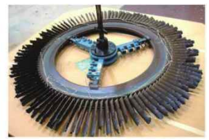
LPT第5段（左側）及び第6段（右側）動翼の損傷状況
