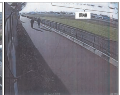
入手した映像をもとに、地上目標物を使用し、推定経路からの進入角の推算（左）、飛行距離と時間から速度の推算（中央）、対地高度の推算（右）を行った事例。
