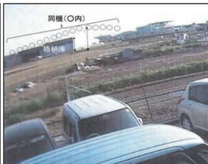
入手した映像をもとに、地上目標物を使用し、推定経路からの進入角の推算（左）、飛行距離と時間から速度の推算（中央）、対地高度の推算（右）を行った事例。
