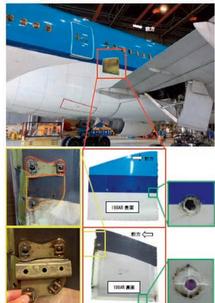
脱落したパネル及びパネル側ブラケットの状態
