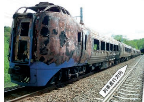
車両の焼損状況
