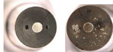
新品 堆積物及び燃料噴射口が閉塞した状態
