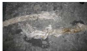
本件ラインの破断状態
