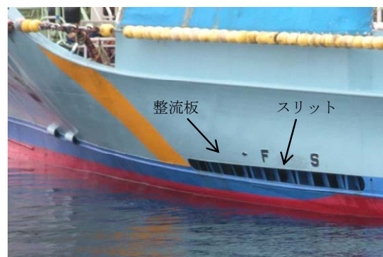
類似船型の網船の放水口
